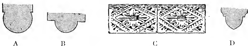
FIG. 219. — Profils à tore unique et tore sculpté.
